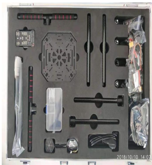
图2-5 大型四旋翼组装套装示例图
