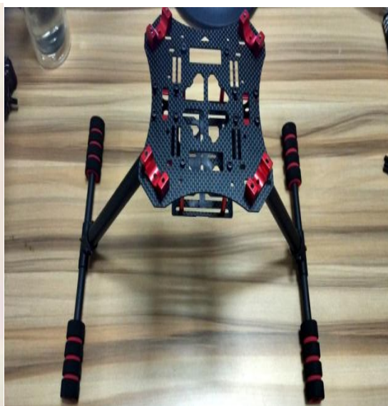
图2-6 无人机机架组装成果示例图
