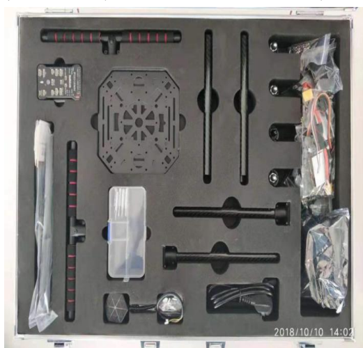
图2-9 大型四旋翼组装套装示例图
